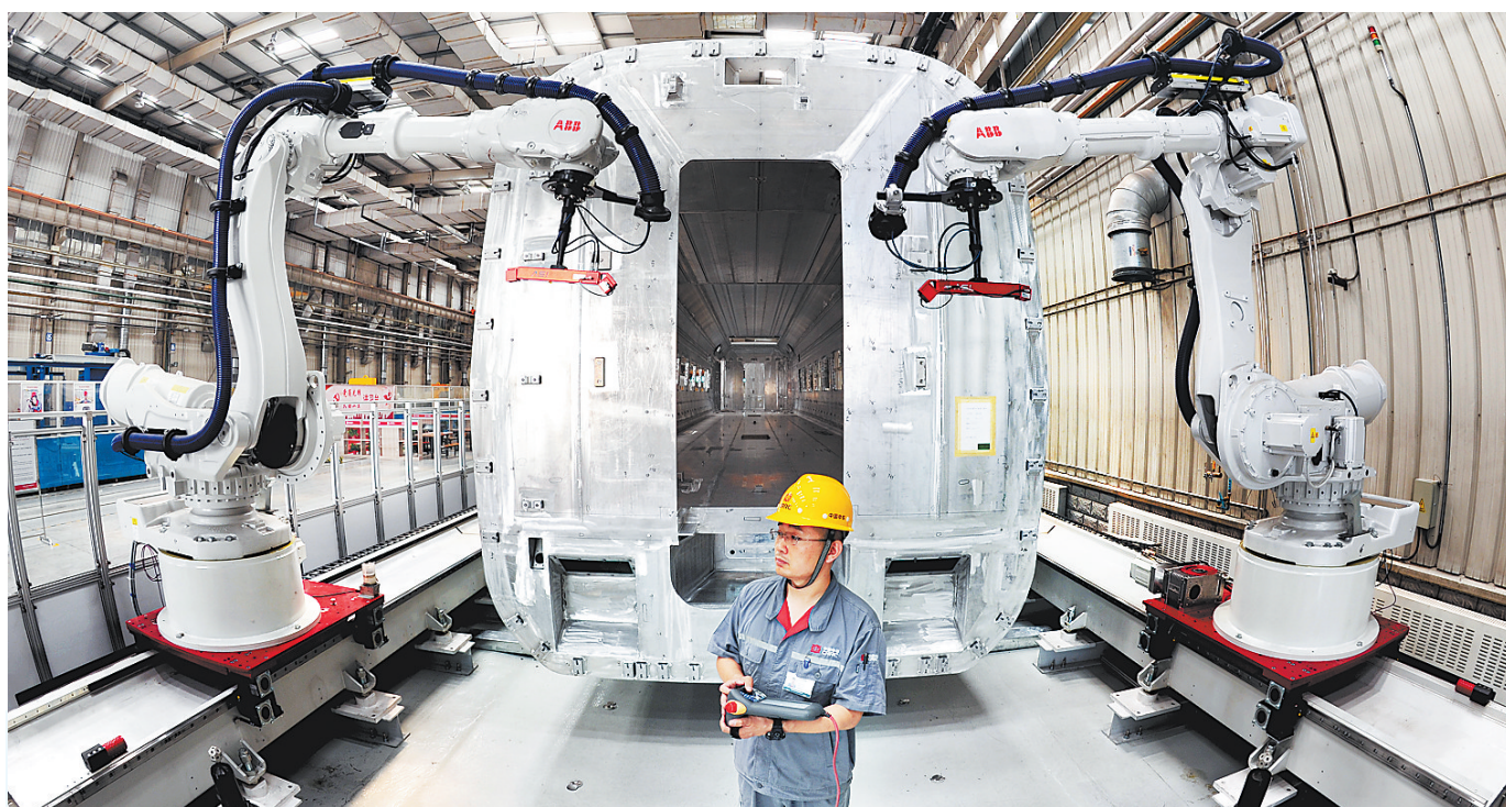
▲日前,在中车唐山公司车体数字化生产线,工人正在操作自动机器人对高速动车组铝合金车体进行数字化测量。
