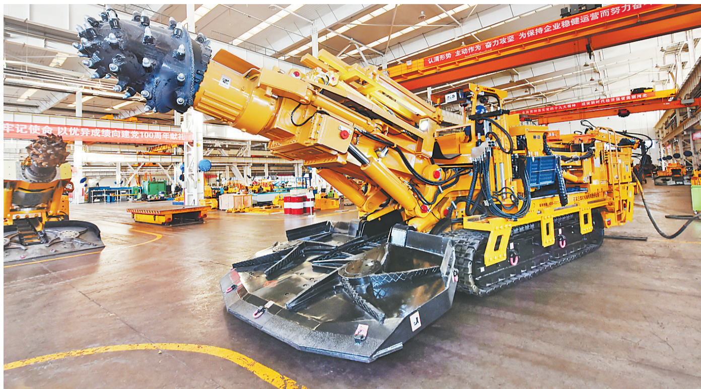
▲11月22日,冀中装备石煤机公司的员工在调试智能四臂掘锚机。 河北日报记者 史晟全摄
