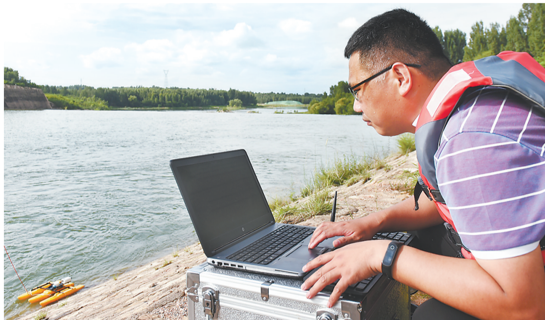
▲7月12日,平山县黄壁庄水文站的工作人员利用走航式测流仪检测水流速。
