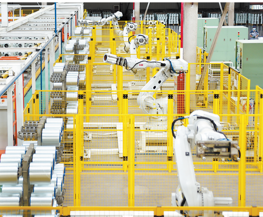
在位于沙河经济开发区的河北冀新材料有限公司,机械手在玻纤生产线工作。该公司生产的中高端玻璃纤维产品,被广泛应用于轨道交通、建材、环保等领域。
