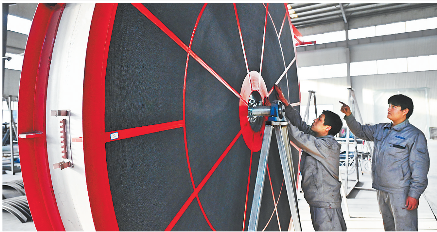
上图：2月19日，拓蓝科技河北有限责任公司的工人正在检测沸石转轮产品性能。该公司积极对接京津优质资源，与贺泓院士团队合作研发了基于沸石分子筛的VOC沸石转轮，该产品在涂装、印刷等多个行业得到广泛应用。河北日报记者 张晚超摄
