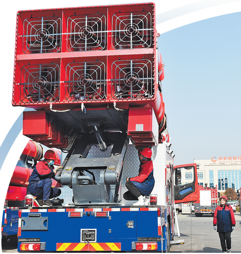
1月27日，润泰救援装备科技河北有限公司员工在组装调试智能化排烟消防车。 河北日报记者 赵永辉摄
