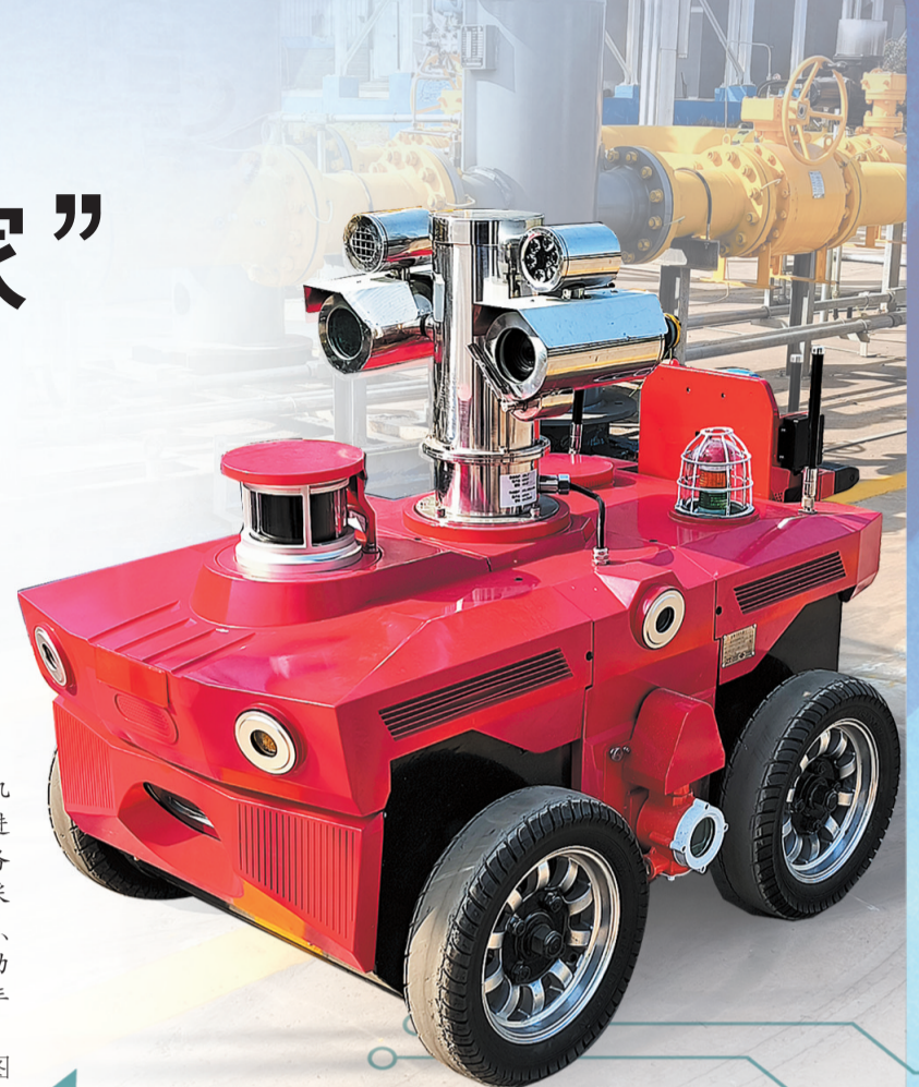
智能巡检机器人在裕泰厂区进行自主巡检，具备自主巡检、数据采集、5G数据传输、分析判断诸多功能。（摄于2023年12月）
