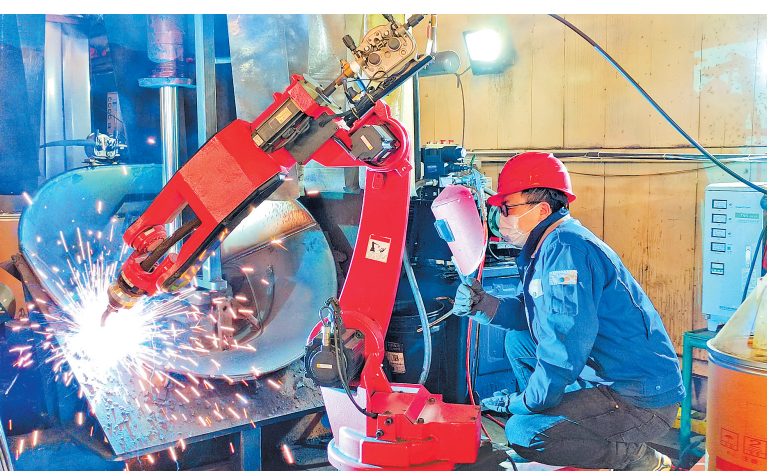
近日,霸州市轩舜永合工贸有限公司工人在利用机械手焊接汽车零部件。近年来,该市借助传统汽车配件产业基础,加快推进产业转型升级步伐,鼓励扶持汽配企业加大技术研发和设备升级改造力度,不断提升产业“智”造能力。 河北日报记者 赵永辉摄
