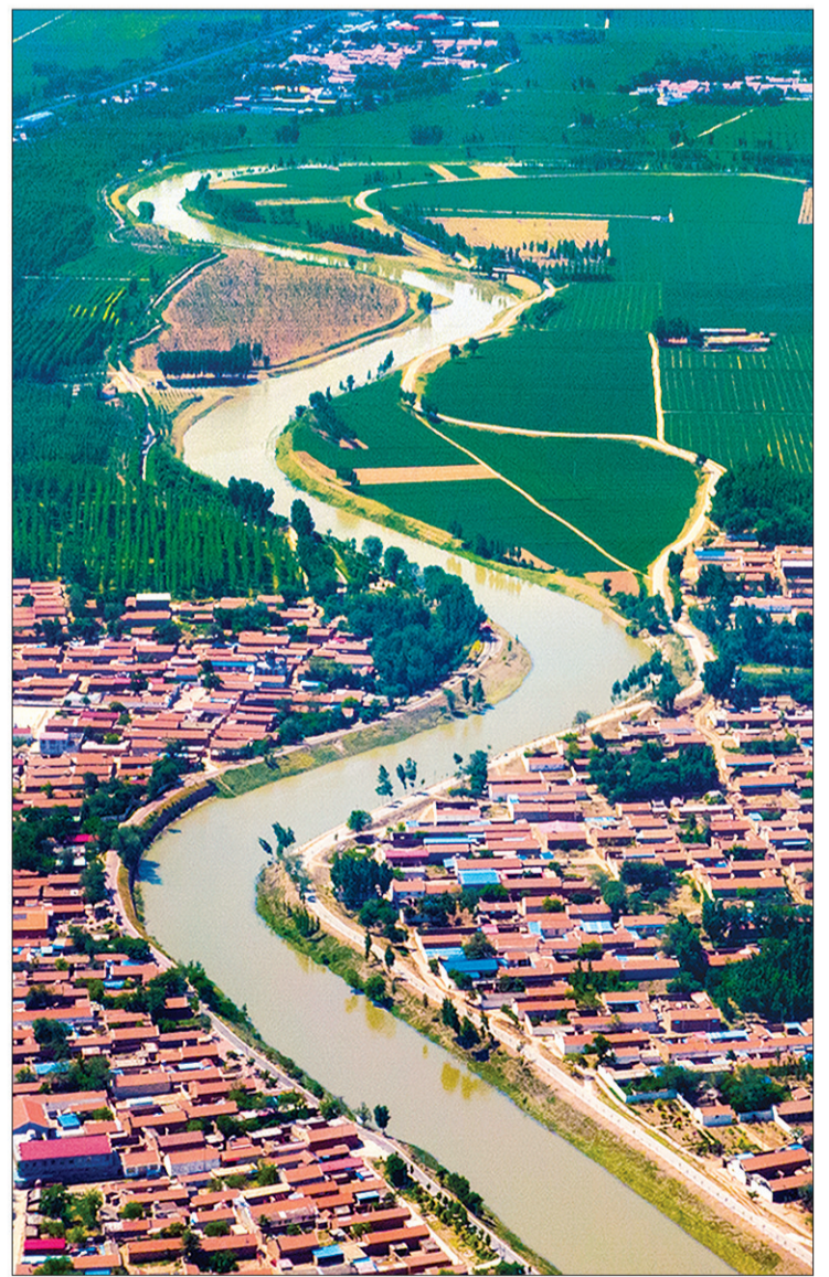
▲大运河沧州段利用自然和人工弯道减缓流速,降低堤坝受力。
