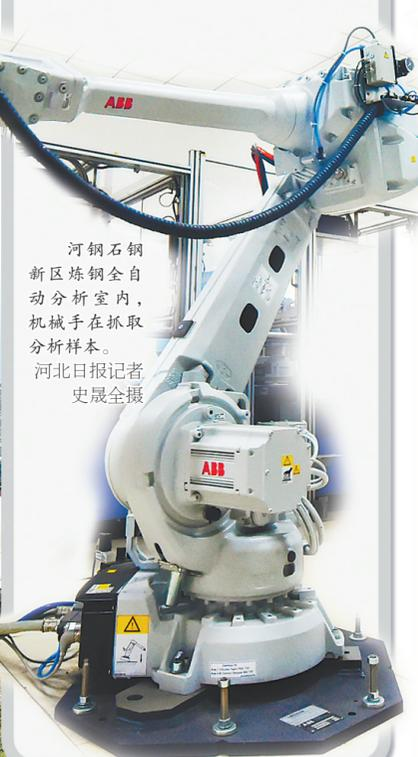
河钢石钢新区炼钢全自动分析室内,机械手在抓取分析样本。河北日报记者 史晟全摄
