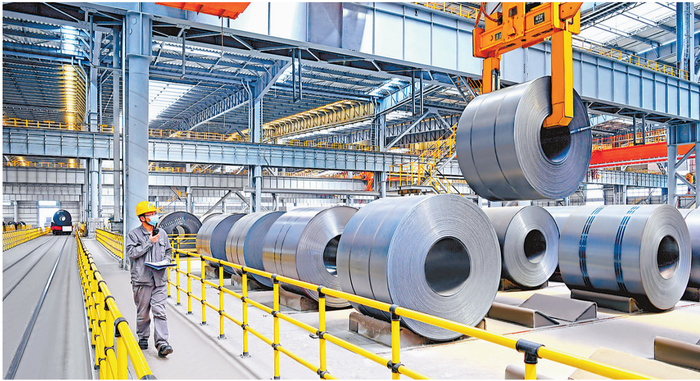
河钢集团唐钢公司工人在查看热轧低合金高强钢产品质量并核对订单信息。
