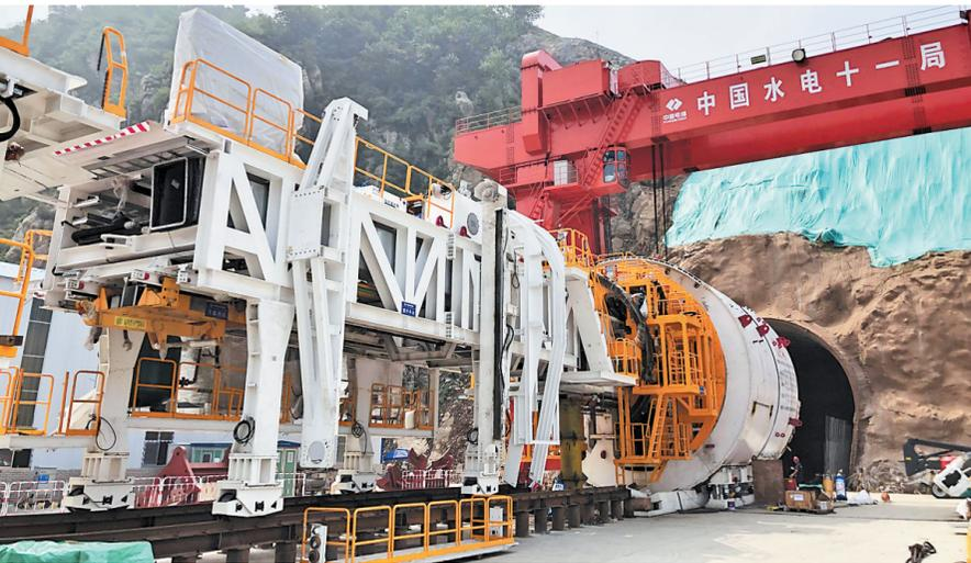
由杜立杰教授团队参研的世界首台大直径超小转弯硬岩掘进机“抚宁号”。石家庄铁道大学供图
