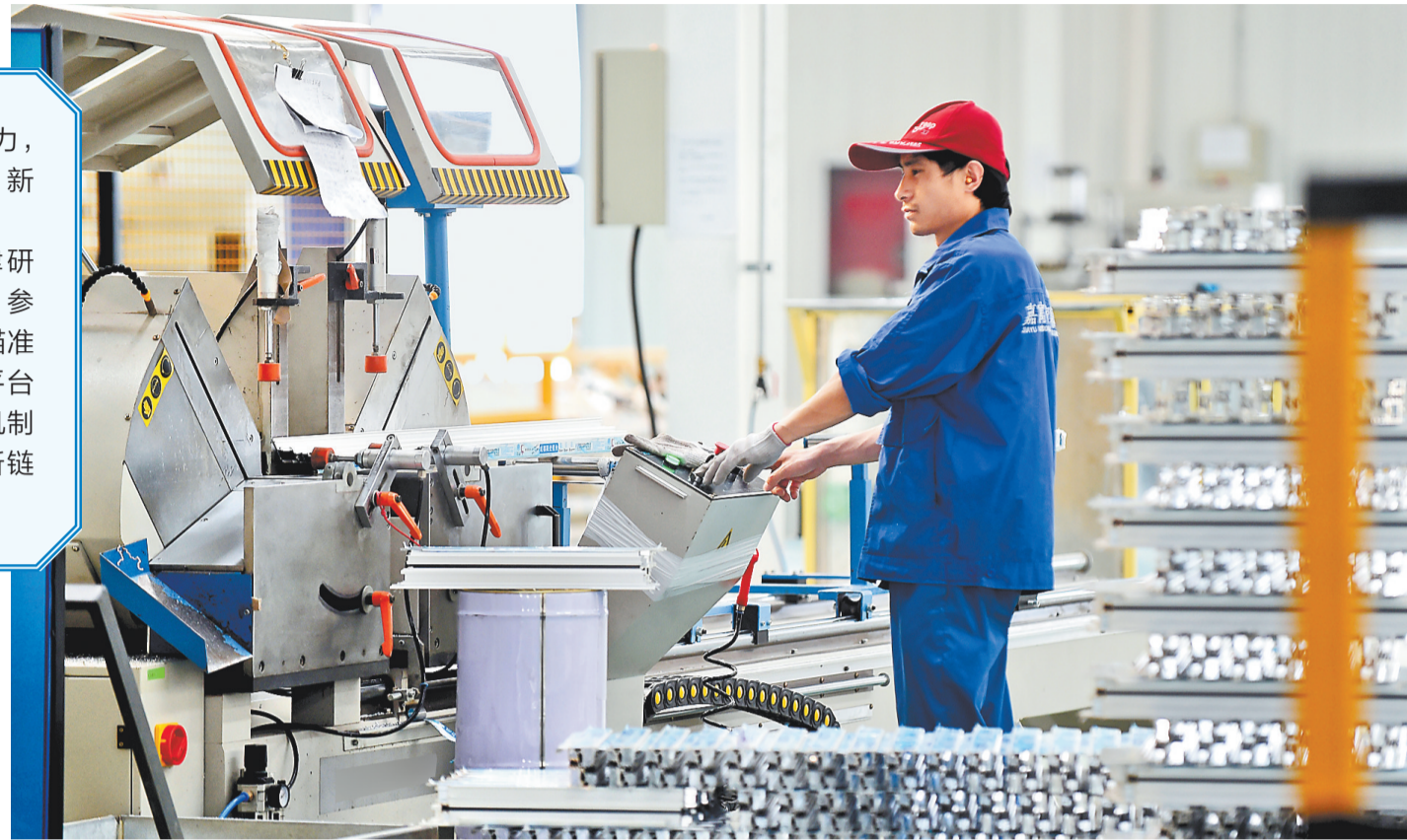
近年来,成县紧抓京津冀协同发展机遇,面向京津实施孵化器招商,先后引进北京嘉寓成县基地、北京德青源金鸡扶贫等一批科技含量高、成长性好、带动力强的绿色低碳产业项目,为全县经济转型升级注入了新动力。图为工人正在北京嘉寓成县基地生产车间利用数控切割锯加工隔热节能门窗产品。(本报资料片)
