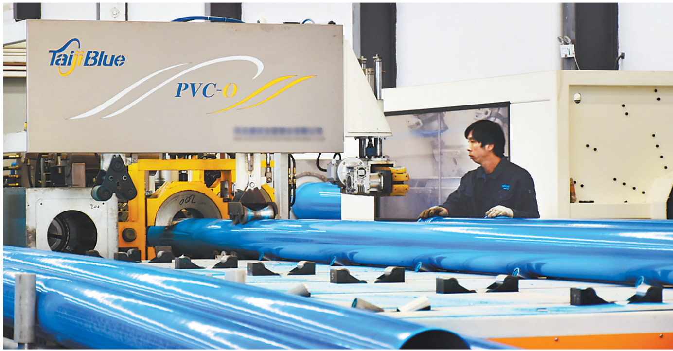
上图:宝塑管业生产车间的PVC-O管道生产线正在运行生产。
