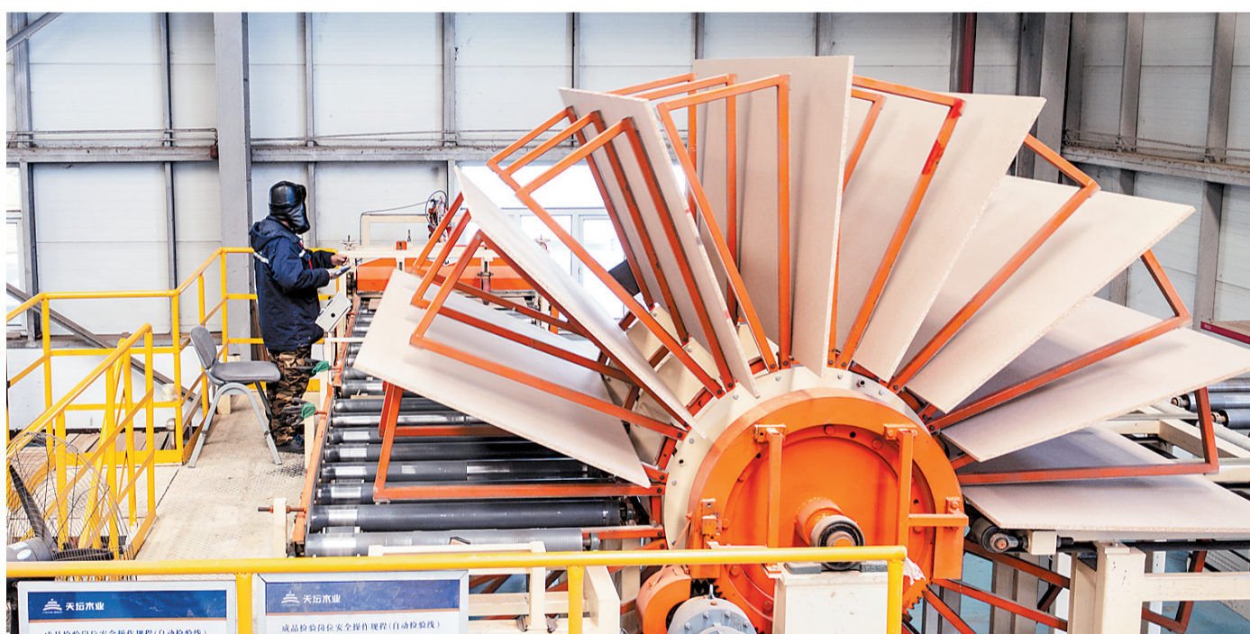
在位于曹妃甸的金隅天坛(唐山)木业科技有限公司,工作人员在自动检板线上进行板材二次检验。 河北日报通讯员 季春天摄
