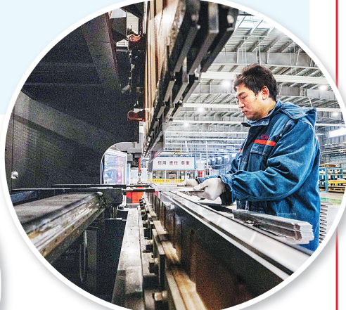
下图:在金隅天坛(唐山)木业科技有限公司,工人在刨花板生产线翻板处进行板材厚度检测。
