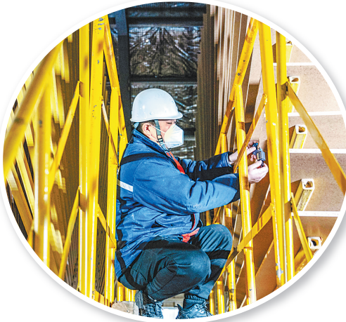
下图:在金隅天坛(唐山)木业科技有限公司,工人在刨花板生产线翻板处进行板材厚度检测。
