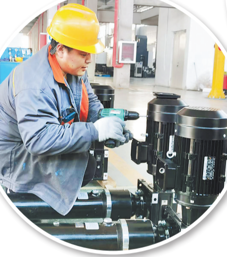
下图:力姆泰克(廊坊)传动设备有限公司是大厂积极承接北京非首都功能疏解的实例之一。这是在该公司精加工车间,员工正在装配单晶炉项目非标电动机。河北日报记者 周禹佳摄
