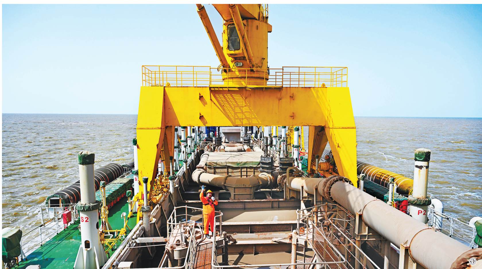
图③:到达指定海域后,神华浚2轮开始抛泥作业。泥舱内的泥沙在20秒内便可倾倒一空。
