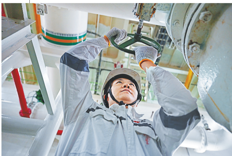
轮机员庞丽军正在检查海水泵排出阀是否转动正常。这些细节问题是他日常工作关注的重点。
