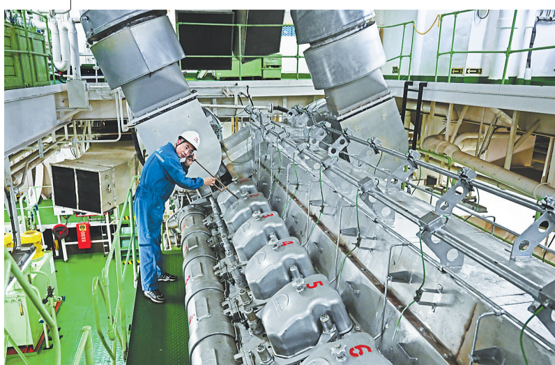
轮机员张国伟使用自制的扩听器,通过听轮船主机声音来判断其是否运转正常。
