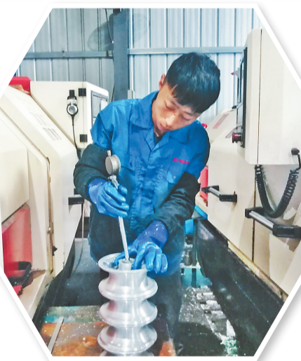
下图:在霸州市宏伟机械有限公司生产车间内,工作人员正在检测铝制电力滑轮质量。
