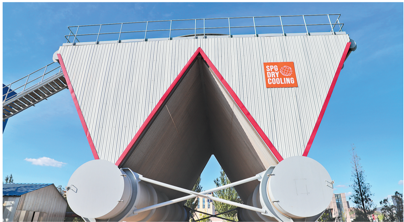
图为9月22日拍摄的斯必高空气冷却技术(张家口)有限公司设计的W型空气冷凝器模拟图。 河北日报通讯员 高阳摄
