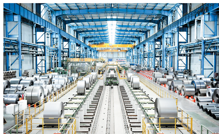
2月18日,在首钢智新迁安电磁材料有限公司新能源汽车用硅钢生产车间内,自动输送机正在运送硅钢产品。河北日报记者 师源摄
