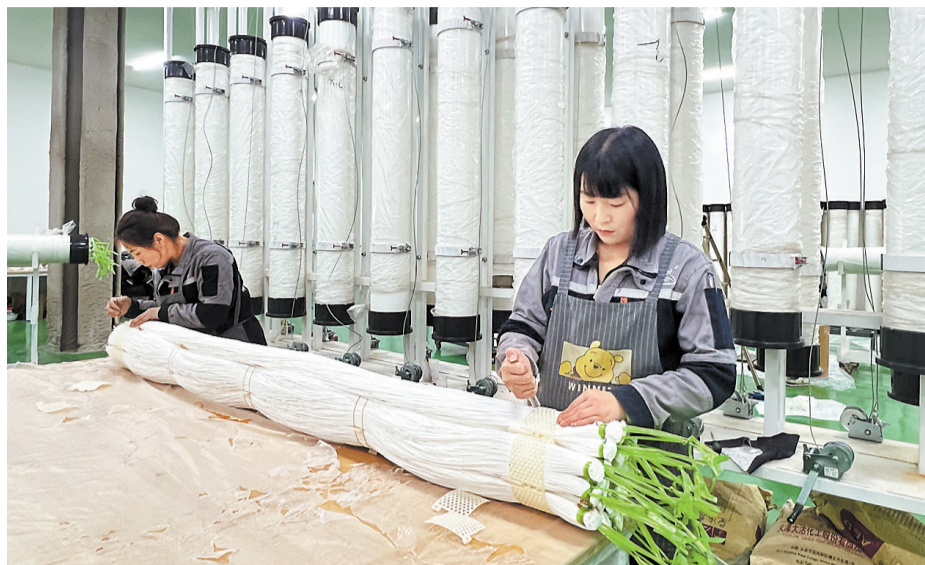
3月1日,位于沧州高新区的海派特膜科技(河北)有限公司组装车间内,工人正在组装柱式膜组件。(本报资料片) 河北日报记者 王雅楠摄
