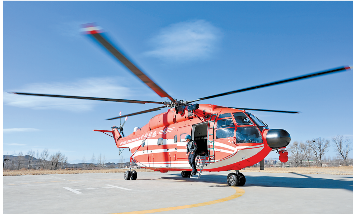
3月19日,在张家口桥东区宇航盛泰航空维修基地,大庆航空救援支队张家口驻防机组进行直升机地面试车。 河北日报记者 郭晓通摄
