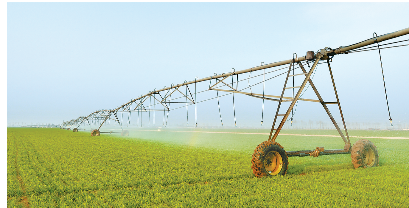
3月21日,宁晋县智琪家庭农场利用指针式喷灌机浇灌冬小麦。
