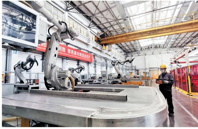
近日,在中车唐山公司关键零部件数字化智能车间,工作人员调试智能化设备对部件进行打磨。
